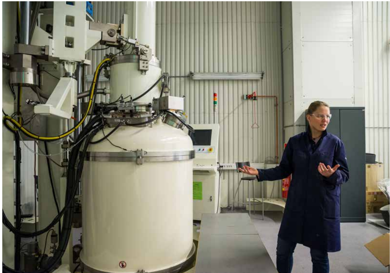
SMELTEOVNER: Silisiumen må smeltes om ved en temperatur på 1400 grader og må stivne igjen før den kan brukes i en solcelle.
